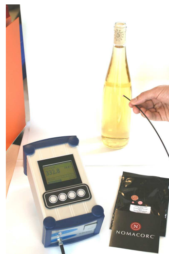
Mesure d'oxygène par sonde Presens
